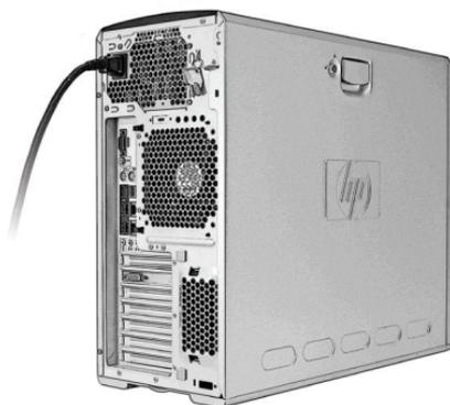
3. 横のパネルを外し、CalDigitのeSATA拡張線をPCの裏にありますポートの接続口にインストールして下さい。
