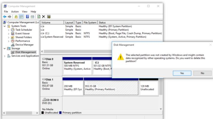
6. Lorsque le disque se connecte, faites un clic droit sur le disque non alloué et sélectionnez "Nouveau volume simple".
